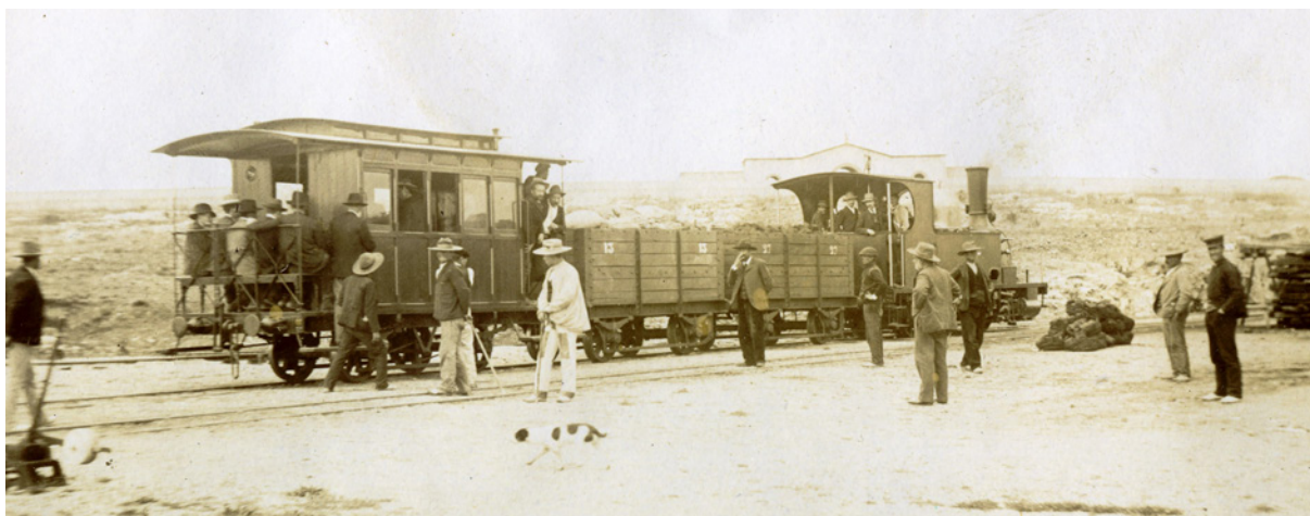
Figura 10. Ferrocarril minero de Bédar a Garrucha en la estación de Garrucha. La imagen muestra una composición de exposición con dos vagones, uno de mineral y otro con otras mercancías, y la jardinera para el personal. La locomotora es la nº 1, llamada la Garruchera. Hacia 1903. Col. Juan Antonio Soler Jódar.
